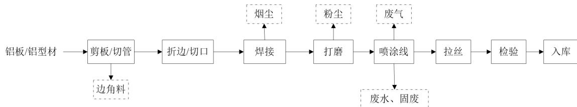
图 2.2-1 产品生产工艺及流程图
