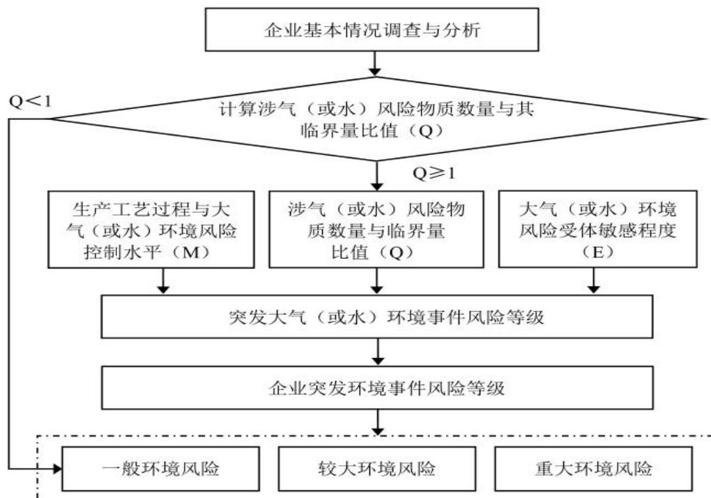
图 3.1-1 企业突发环境事件风险分级流程示意图
