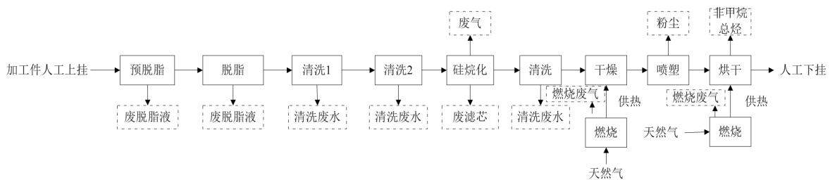
图 2.2-2 喷涂线工艺及产污环节图
